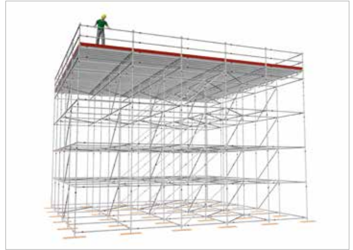
Image 66 : Exemple d'échafaudage spatial
