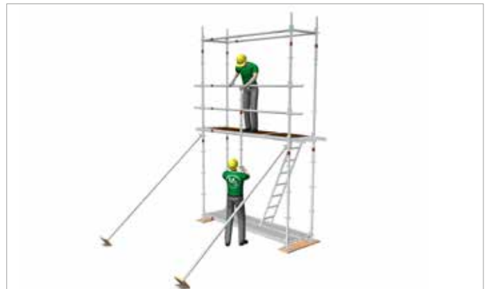
Image 2: Exemple d'une protection temporaire contre le basculement de la première couche de l'échafaudage lors du montage d'un échafaudage de façade
