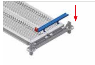
Image 25 : Placer la sécurité de levage dans le profilé en U et introduire les ancrages de sécurité dans l'évidement du profilé en U
