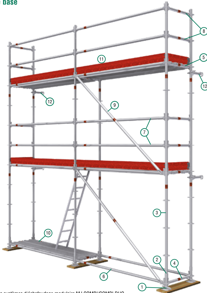
Image 7 : Éléments de base des systèmes d'échafaudage modulaire MJ COMBI/COMBI DUO
