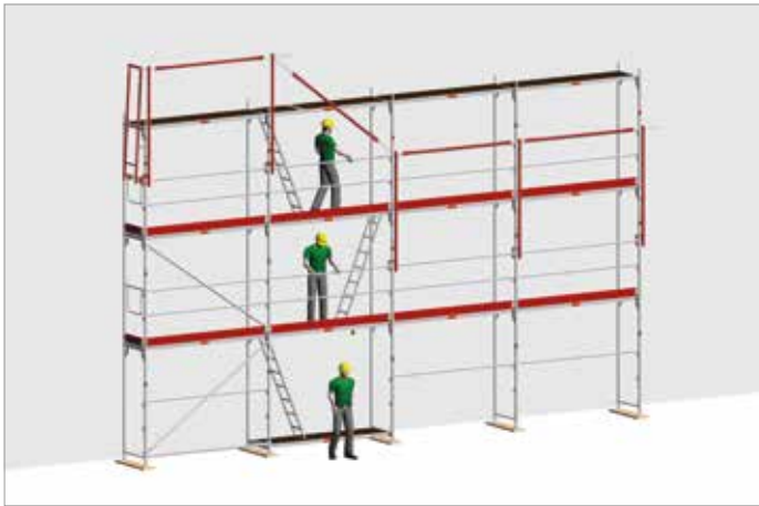
Image 37 : Placer haut le garde-corps de sécurité de montage (MSG)
