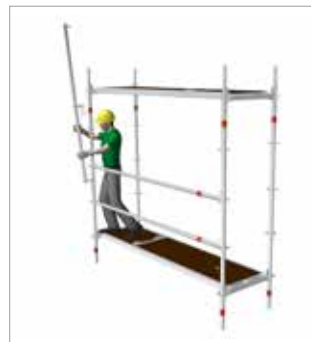
Image 67 : Montage du premier poteau d'échafaudage
