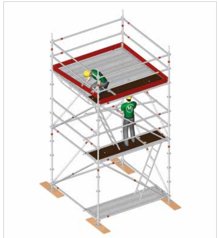
Image 62 : Niveau intermédiaire entièrement monté sans planchers d'échafaudage et aménagement du niveau de travail, y compris protection latérale par des plinthes ainsi que des traverses
