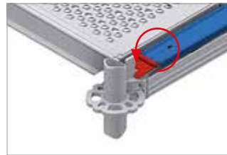
Image 27 : Rabattre la languette de la sécurité de levage vers le bas et bloquer ainsi la sécurité de la plancher
