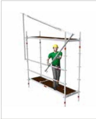
Image 69 : Montage du deuxième poteau MSG avec la lisse de garde-corps suspendue (en bas)
