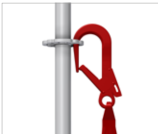
Image 75 : Ancrage à n'importe quel disque perforé à l'intérieur d'un plan de plancher déjà monté
