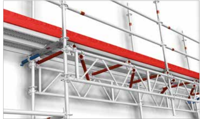
Image 54 : Exemple 2 d'un pont de poutres en treillis avec ancrage et contreventement de la membrure supérieure
