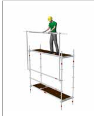
Image 70 : MSG monté sur le côté longitudinal de l'échafaudage (à droite)
