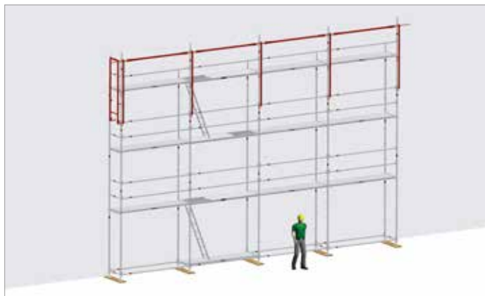
Image 36 : Montage de la couche d'échafaudage suivante à l'abri du garde-corps de sécurité de montage (MSG)
