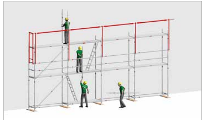
Image 3 : Exemple de transport vertical manuel d'éléments d'échafaudage
