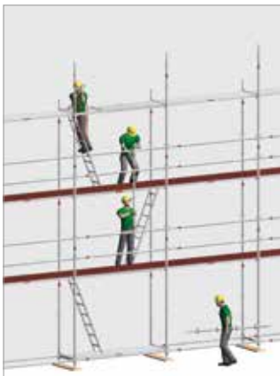
Image 38 : Exemple 1 pour le montage de l'échafaudage avec équipement de protection individuelle contre les chutes
