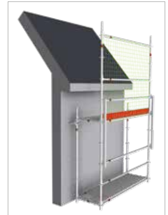
Image 52 : Mur de protection - formation avec des tubes de renfort au niveau de l'union, à hauteur du plancher
