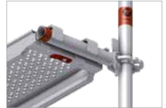
Image 21 : Poser la griffe d'appui du plancher sur la traverse
