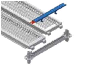
Image 24 : Placer les planchers dans le profilé en U et relever la languette du dispositif de sécurité
