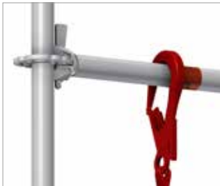
Image 74 : Ancrage à une traverse O à n'importe quel endroit, avec un montant non abouté dans le plan du plancher, aussi bien à 1,0 m qu'à 2,0 m de hauteur au-dessus du plan du plancher
